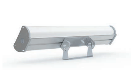
V4-10-70.0087.IRO-0001 Поворотное крепление для 1 светильника Размер крепления 192x45x80мм Угол поворота 180°, шаг 15°
