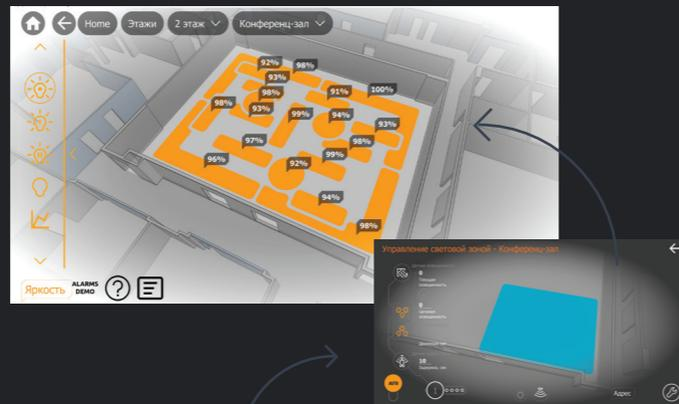
Датчики контролируют зону, состоящую из нескольких рабочих мест. Расставляются таким образом, чтобы обеспечить полное покрытие опенспейса. Датчики могут управлять как каждой зоной независимо друг от друга, так и включать все освещение в опенспейсе независимо от того в какой зоне сработал датчик движения. Около окон датчики регулируют яркость светильников в соответствии с заданными настройками.
