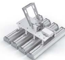
V4-IO-70.0002.IR0-0003 Поворотное крепление для 4 светильников Размер крепления 465x362x276мм (при положении скобы перпендикулярно светильникам) Угол поворота 180°, шаг 15°
