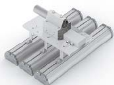
V4-IO-70.0003.IR0-0001 Консольное крепление для 3 светильников Размер крепления 385x220x276мм Установка на консоль диаметром 40÷50мм
